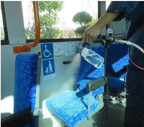
コーティング作業の様子
